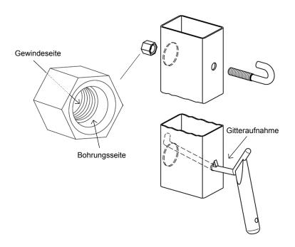
Die Hakenschraube M8 x 65 in die 9-mm-Bohrung in der Frontseite des LEGI-Pfostens RP pur R einführen.
