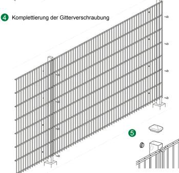
Die fehlenden Schraubverbindungen wie unter 2 beschrieben herstellen, jedoch können diese gleich festgezogen werden.
