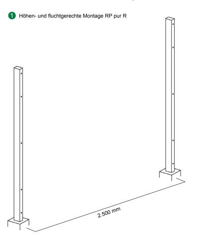
Höhen- und fluchtgerechte Montage der LEGI-Rohrpfosten RP pur R mit einem Achsmaß von 2500 mm.
