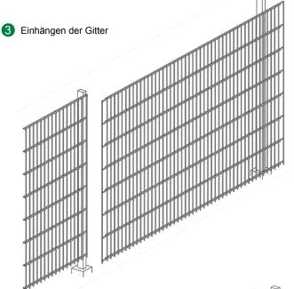
Die Gitter gemäß dem LEGI-R-System überlappend in die vormontierten Hakenschrauben einhängen, wobei die Gitter wahlweise mit den überstehenden Drahtenden nach oben oder nach unten montiert werden können.
